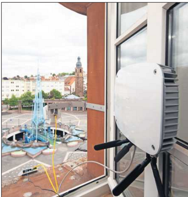
Ein wetterfester Profi-Wlan-Router vor dem Fenster im obersten Stock des Rathauses sorgt auf dem Exerzierplatz für kabellosen Datenempfang. (Foto: Archiv/Stegner)
